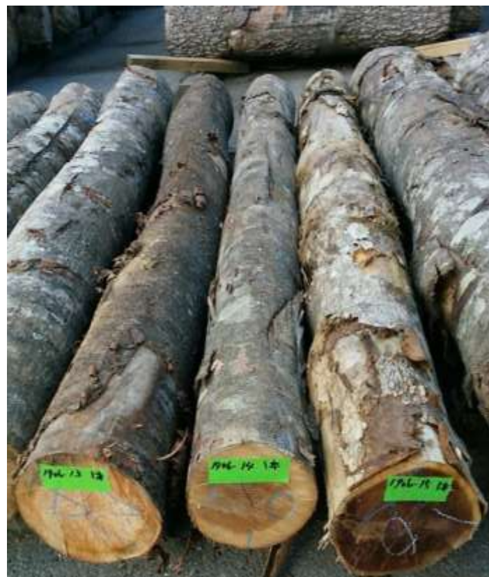
樹種: ホオノキ 材長: 2.2m 管理No. 14 径級: 22cm 本数: 1 材積: 0.106 m 3
