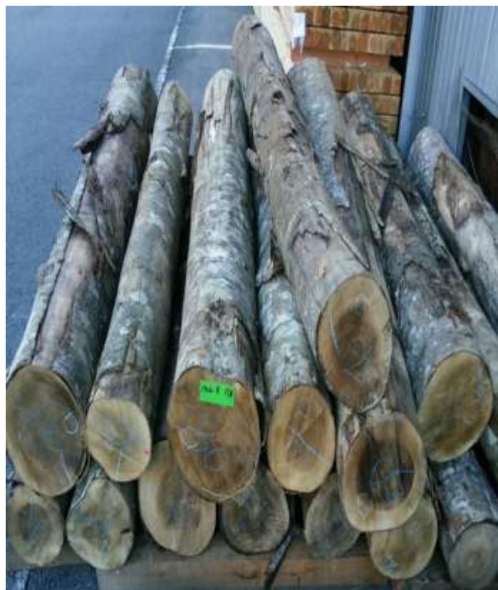
樹種: ホタキ、シナ 材長: 1.8-2.2m 管理No. 8 径級: 20cm-32cm 本数: 17 材積: 2.370 m 3
