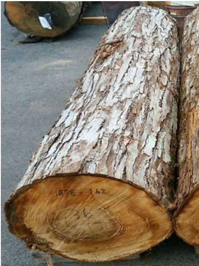
樹種: カツラ 材長: 2.2m 管理No. 162 径級: 36cm 本数: 1 材積: 0.285 m 3
