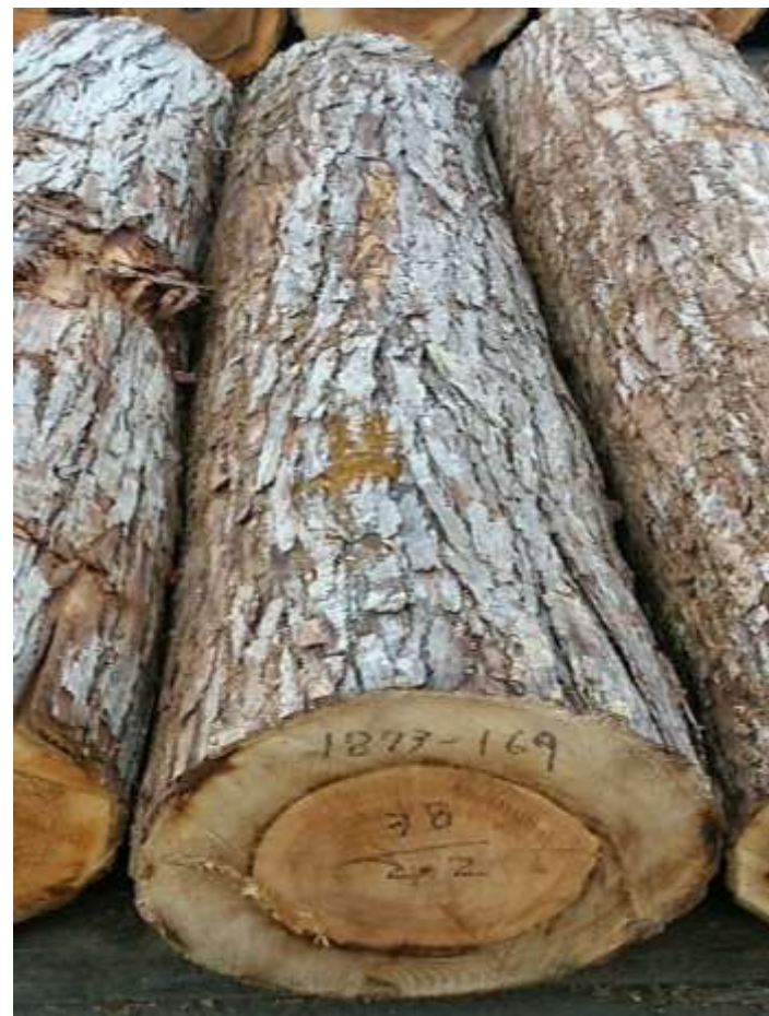
樹種: カツラ 材長: 2.2m 管理No. 169 径級: 38cm 本数: 1 材積: 0.318 m 3
