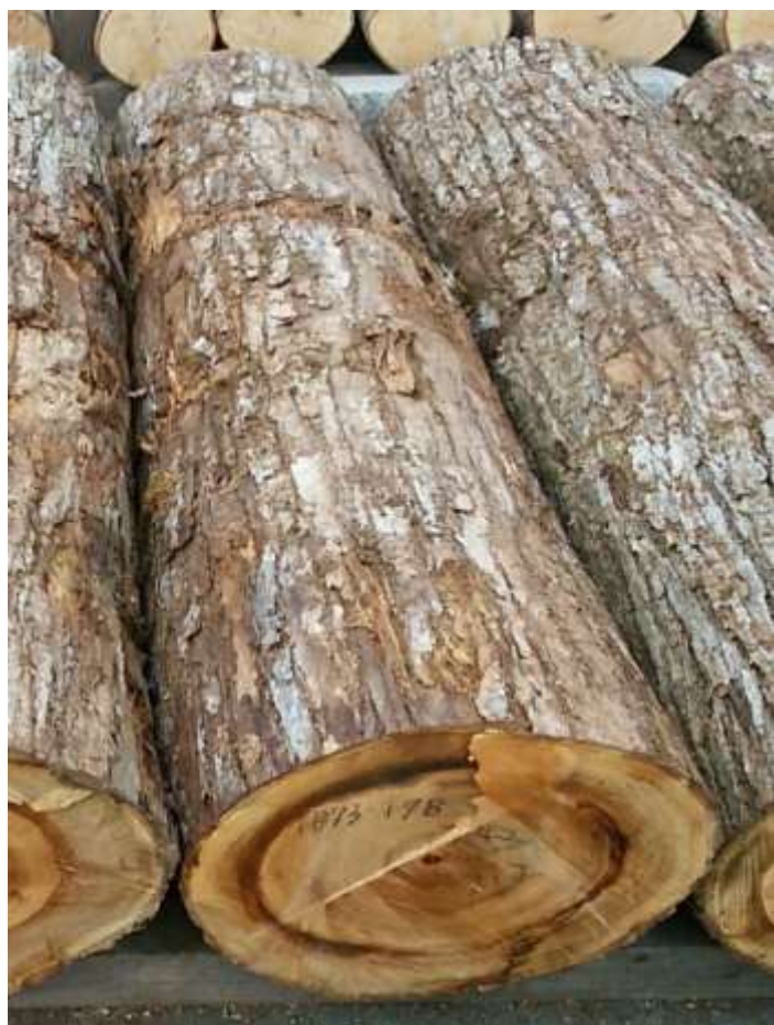
樹種: カツラ 材長: 2.2m 管理No. 178 径級: 42cm 本数: 1 材積: 0.388 m 3
