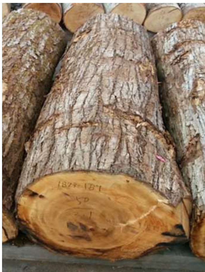
樹種: カツラ 材長: 2.1m 管理No. 181 径級: 50cm 本数: 1 材積: 0.525 m 3
