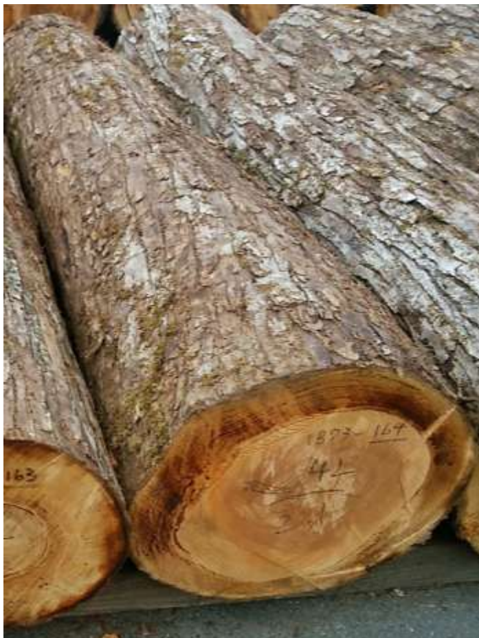
樹種: カツラ 材長: 2.1m 管理No. 164 径級: 42cm 本数: 1 材積: 0.370 m 3
